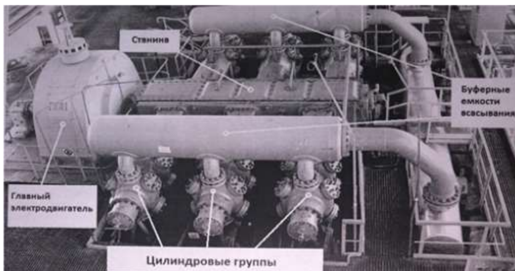
Рис. 3. Ряд компрессора в разрезе
