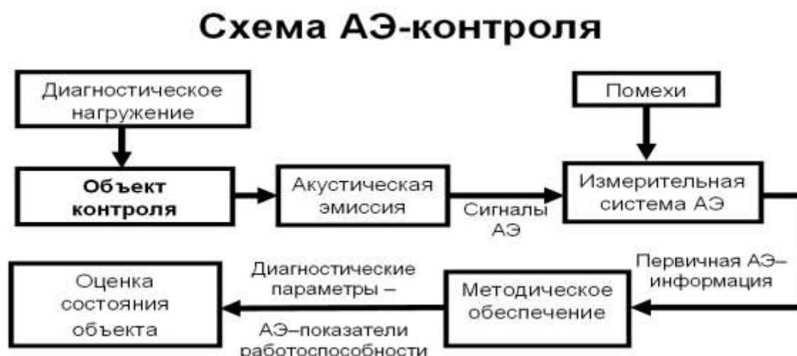
Рис. 2. Принципиальная схема акустико-эмиссионного контроля
